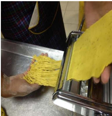
Gambarajah 5 : Proses pembentukan mi ikan menggunakan mesin mi
